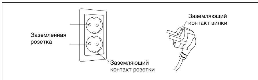
Рисунок 59 — Правильное заземление массажного кресла
