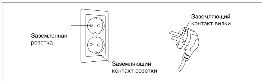
Рисунок 21 — Правильное заземление массажного кресла
