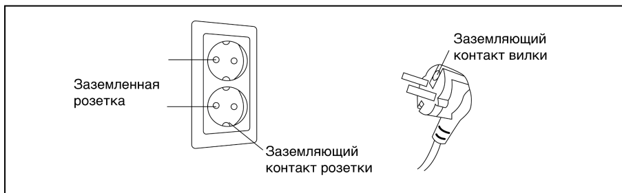
Рисунок 14 — Правильное заземление массажного кресла
