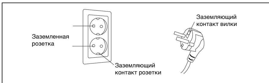
Рисунок 15 — Правильное заземление массажного кресла
